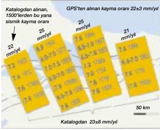
Şekil 3. 500 yıllık kataloga bağlı olarak yapılan Şekil 2'den elde edilen sismik kaymalar, Marmara Denizi ve yakınındaki Kuzey Anadolu Fay sistemine dik alınan dört kesitte özetlenmiştir. Büyüklüğünün yaklaşık 7 ve üzerinde olduğu aletsel verilerle kesin bilinen ya da böyle olduğu hesaplanan bütün tarihsel depremler kullanılmıştır. Ortalama sismik enerji, açığa çıkma oranı GPS verilerinden elde edilen enerji birikimini dengelemektedir. Parantez içinde verilen depremlerin verilen kesitlere kadar uzanıp uzanmadığı tam olarak belli değildir (1766a Mayıs; 1766b Ağustos).
